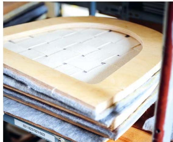
Naheliegenderes Recycling: Der Filz für die Unterfederung wird aus Stoffresten gefertigt
