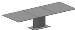
**Socket 6b**    **Flachoval (gegen Aufpreis)**    Flachovalsockel V2A matt geschliffen 16 x 53,5 cm Bodenplatte V2A matt geschliffen 40 x 76 cm
